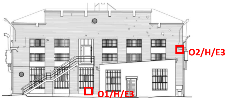
Rys. 8. Schemat rozmieszczenia odkrywek – elewacja wschodnia.
