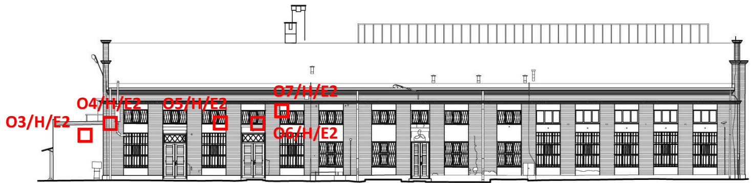
Rys. 9. Schemat rozmieszczenia odkrywek na elewacji północnej.
